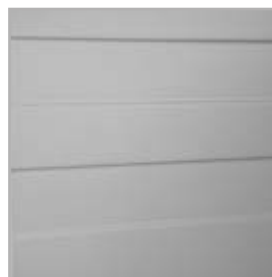
frézování na povrchu křídla v šířce 30 mm u vzorů B7–B9
